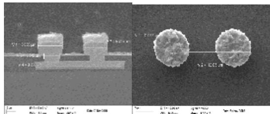
图 12 10 $\mu\text{m}$ /5 $\mu\text{m}$  (间距/直径) 窄节距微凸点
