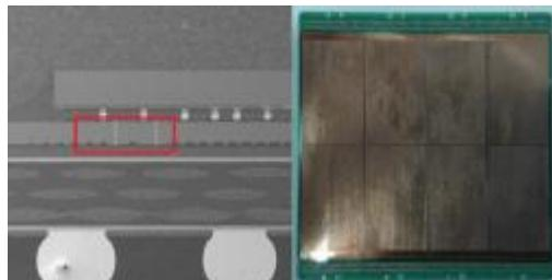
图 2 本项目为重大科学装置提供的硅通孔转接板系统集成产品
